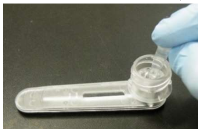
② PCRチューブをカセット にそのまま挿し込みます
