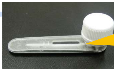
③ キャップを締めることで PCR反応液がPASにしみ込みます。
